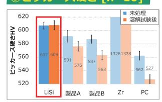
「LiSi」及び「Zr」のビッカース硬さは溶解試験後 に有意な変化を確認できなかった。
